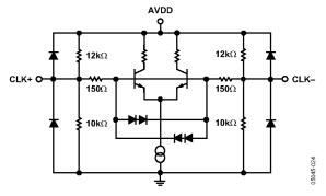
Figure 24. Clock Inputs
